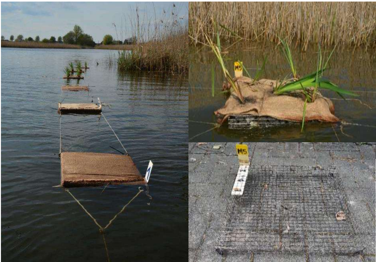
Abbildung 14: Gescheiterter Versuch der Einführung eines neuen Floßtyps für den Standort Millinger Meer. Der aus Edelstahl und künstlichem Bimsstein gefertigte Floßtyp war entgegen unseren Erwartungen den Bedingungen in freier Natur nicht gewachsen. Der Bimsstein rieb sich mit der Zeit aneinander ab, so dass nichts übrigblieb und die Flöße versanken (siehe rechte Seite Floß M5: oben Zustand 2022; unten 2024 – der Bimsstein war vollständig verschwunden).
