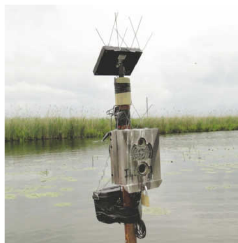
Abb. 3: Fotofalle (Spypoint IR6) in Metallgehäuse mit externem Akku sowie Solarpanel. Foto: A. Vossmeier
